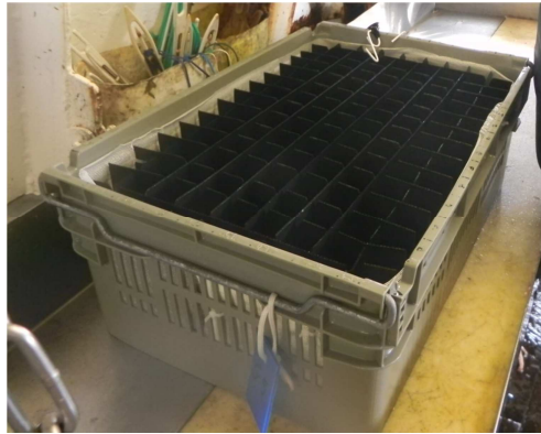
Figure 2: Caisse alvéolée pour le maintien en captivité des langoustines
